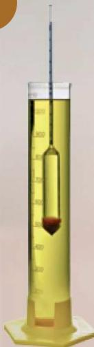
Coloque a quantidade de 1 litro de diesel a ser examinado em uma proveta, de modo que o densímetro flutue livremente, sem tocar o fundo ou as paredes da proveta.
