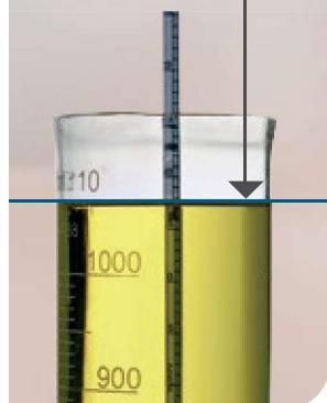
Introduza o termômetro, tendo o cuidado de manter a coluna de mercúrio totalmente imersa. Uma vez estabilizada a temperatura, efetue a leitura e anote.
