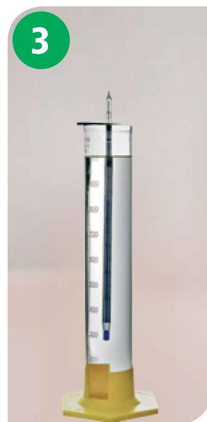
Introduza o termômetro, tendo o cuidado de manter a coluna do mercúrio totalmente imersa. Uma vez estabilizada a temperatura, mantendo o termômetro imerso no etanol, efetue a leitura e anote.
