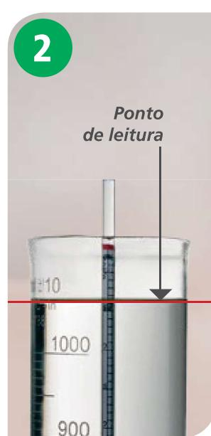
Mergulhe o densímetro limpo e desengordurado no produto, sem tocar as paredes da proveta.
