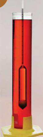
Coloque a quantidade de 1 litro de diesel a ser examinado em uma proveta, de modo que o densímetro flutue livremente, sem tocar o fundo ou as paredes da proveta.
