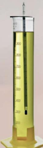
Mergulhe o densímetro limpo e desengordurado no produto. Ao soltá-lo, faça um movimento giratório para que ele entre rapidamente em equilíbrio e flutue livremente, sem tocar as paredes da proveta.
