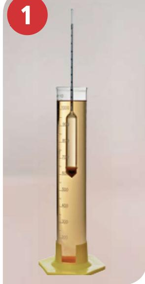
Coloque a quantidade de 1 litro de gasolina a ser examinada em uma proveta, de modo que o densímetro flutue livremente, sem tocar o fundo ou as paredes da proveta.
