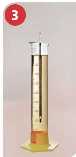
Mergulhe o densímetro limpo e desengordurado no produto. Ao soltá-lo, faça um movimento giratório para que ele entre rapidamente em equilíbrio e flutue livremente, sem tocar as paredes da proveta.
