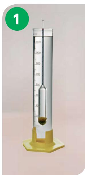
Coloque a quantidade de 1 litro de etanol hidratado a ser examinado em uma proveta, de modo que o densímetro flutue livremente, sem tocar o fundo ou as paredes da proveta.
