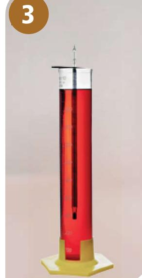
Mergulhe o densímetro limpo e desengordurado no produto. Ao soltá-lo, faça um movimento giratório para que ele entre rapidamente em equilíbrio e flutue livremente, sem tocar as paredes da proveta.
