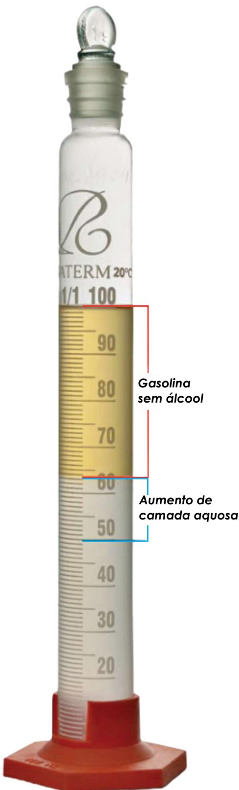
**Coloque 50 ml da amostra de gasolina na proveta previamente limpa, desengordurada e seca.**
