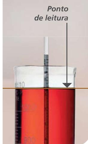
Introduza o termômetro, tendo o cuidado de manter a coluna de mercúrio totalmente imersa. Uma vez estabilizada a temperatura, efetue a leitura e anote.
